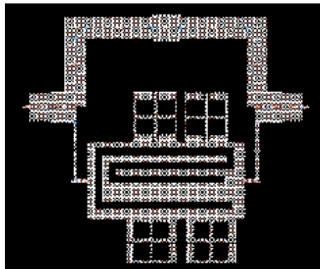
Gambar 1. Desain filter mikrostrip multiband menggunakan metode notch Band
