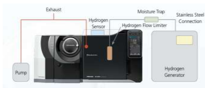
Gambar 3. Konfigurasi GC-MS dengan hydrogen gas sensor
