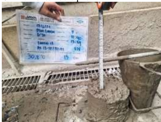
Gambar 2. Uji slump beton di lapangan
