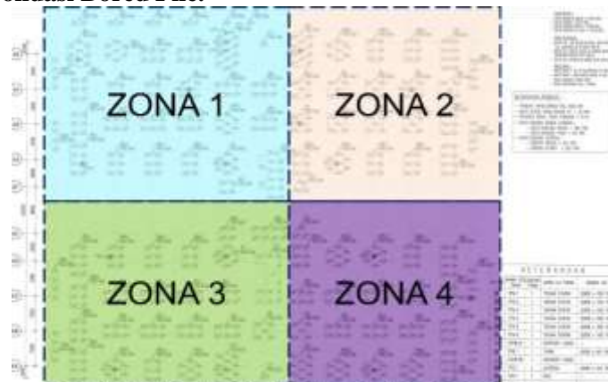
Gambar 4. Pembagian zona pondasi bored pile
