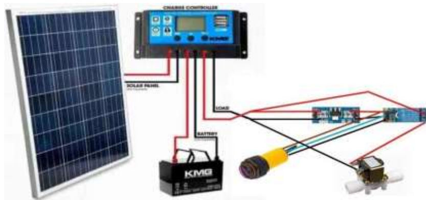
Gambar 2. Skema rangkaian kran air otomatis berbasis PLTS
