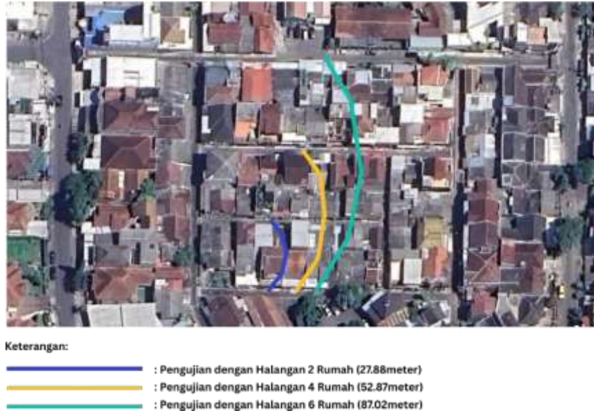
Gambar 3. Skema pengujian komunikasi dengan halangan rumah
