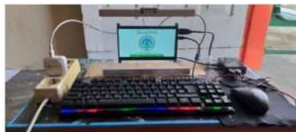
Gambar 4. Rancangan keseluruhan alat smart schedule displayer
